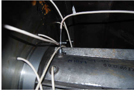
Рисунок 5 – Измерение полного давления в сечении 0-0
